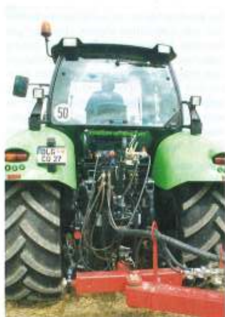
Gute Hubkräfte haben beim Agrotron Tradition. 120 l/min Öl für die maximal vier Steuergeräte sind ok.
