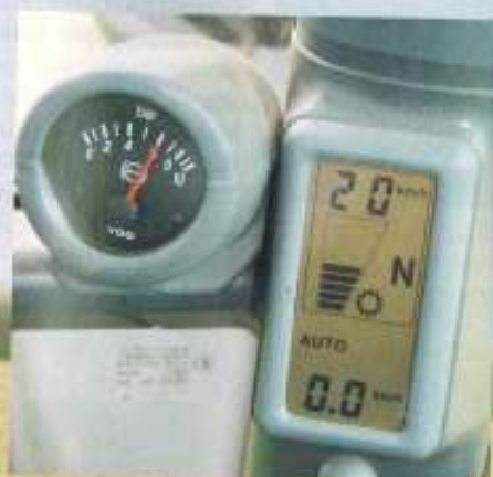
Am rechten Kabinenpfosten werden die gewählte Geschwindigkeit, Tempomataktivierung und der Betriebsmodus angezeigt.
