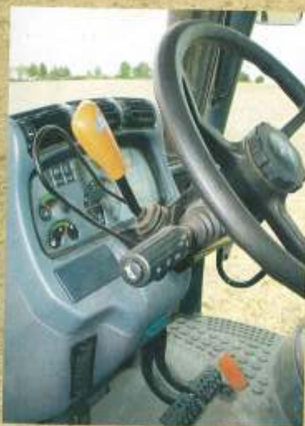
Bei vorgewählter Fahrtrichtung hat das ZF-Stufenlos-Getriebe eine aktive Haltefunktion. In Stellung „Neutral“ nicht.
