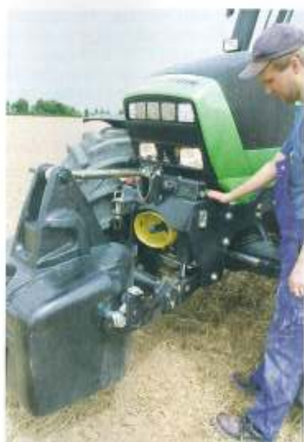
Den Frontkraftheber liefert Sauter zu. Die Bedienung der E-Hydraulikventile per Tastendruck vorn ist Wunschausstattung.
