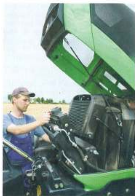
Das neue Kühlerpaket lässt sich schön hochklappen. Leider kann sich Schmutz unten am Fuß der Kühler ablagern.
