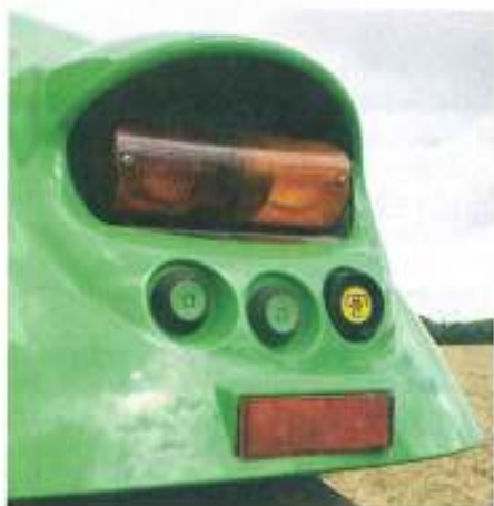
Zapfwellen- und EHR-Bedienung am Heck hat sich bewährt. Eine Bedienung für ein Steuergerät auf den Kotflügeln fehlt leider.
